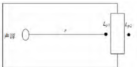
图 5.4-1 室内声源等效为室外声源图例
