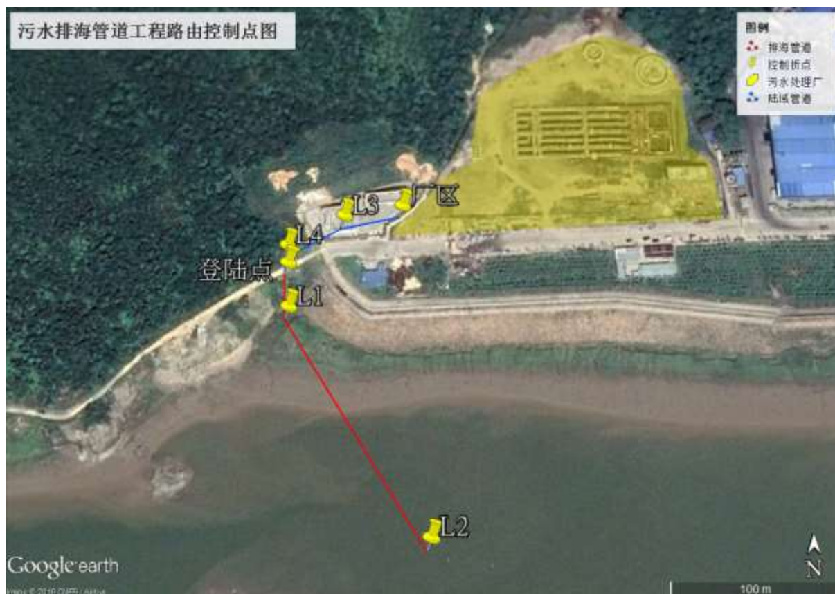
图 2.2.1-1 污水排海工程路由控制点示意图
